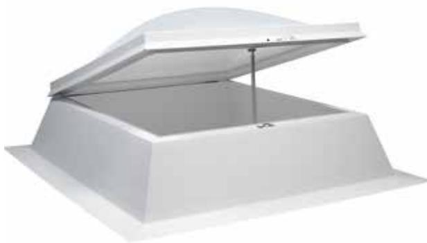
Lichtkuppel LK classic in PC-st Verglasung mit Aufsetzkranz AK PVC in 30 cm Höhe und Linearantrieb – Lüftungsposition
