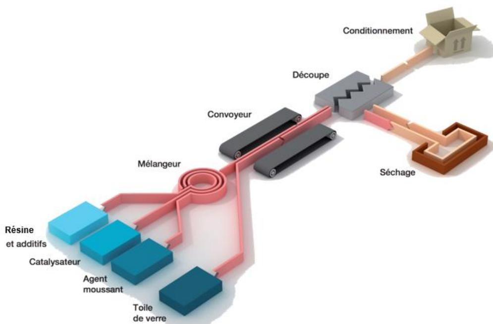
La mousse phénolique est produite grâce à l'utilisation de résine résolique, de catalyseur, agent moussant (gonflant) et additifs.
