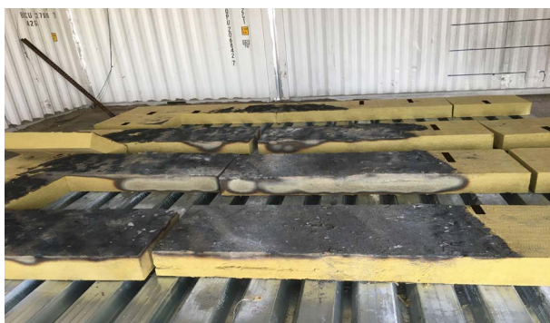
De dag na de test leken de platen nog steeds heet te zijn. Vervolgens werd een thermokoppel geplaatst in deze platen
