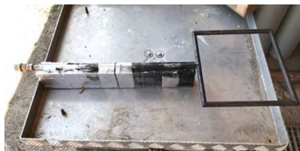
Weergave van de in de testen gebruikte gasbrander
