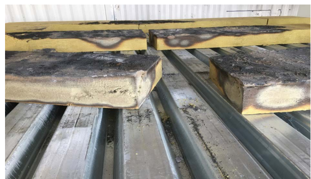
die gedurende de nacht buiten opgeslagen waren. Hierbij werden temperaturen tot 160°C geregistreerd.
